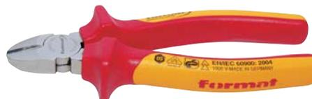
**N35306** - Tronchesi a taglienti diagonali **con durezza ca. 62 HRC**, DIN ISO 5749, in acciaio al vanadio forgiato, **esecuzione cromata lucida**, impugnature ergonomiche bimateriali VDE, **conformi alla norma europea EN 60900**, per utilizzo in circuiti sotto tensione **fino a 1000V** in corrente alternata.
